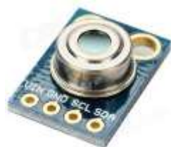
Рис.2. Инфракрасный датчик MLX90614
