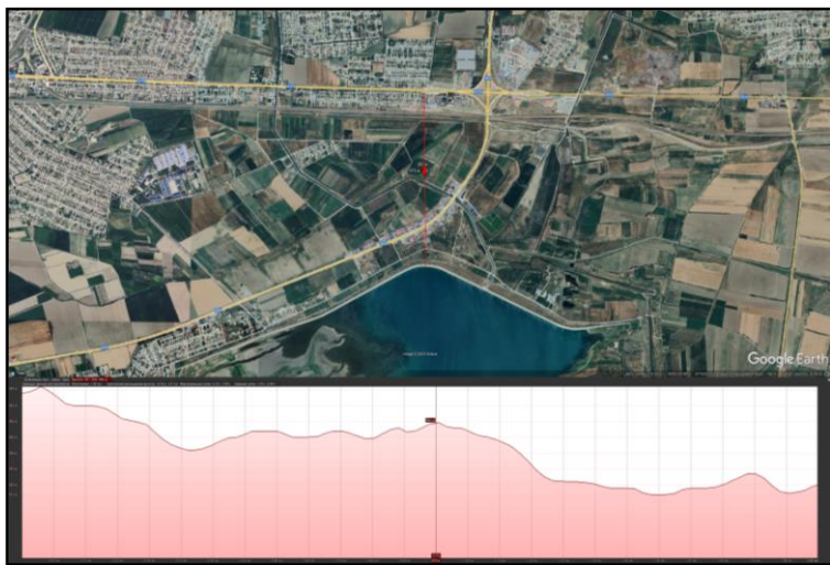
2-rasm. Tog'ondan aholi punktigacha chiziqli obyekt relefining profili
