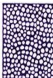
1-rasm. Tuzilishga ko'ra yengil betonning turlari. a) yirik g'vakli
