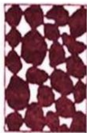
1-rasm. Tuzilishga ko'ra yengil betonning turlari. a) yirik g'vakli
