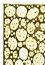
1-rasm. Tuzilishga ko'ra yengil betonning turlari. a) yirik g'vakli
