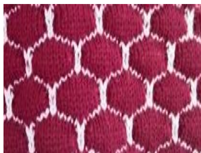
4-rasm. Ikki qatlamli trikotaj to'qimalarining ko'rinishi hamda grafik yozuvi
