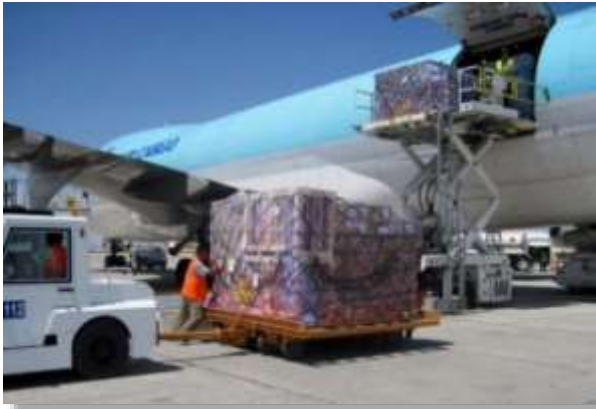
2-rasm. Boeing B-747-400F samolyotining sof yuk tashuvchi modifikatsiyasi O'zbekiston Respublikasining "Navoiy" xalqaro aeroportida (yuklash jarayoni)
